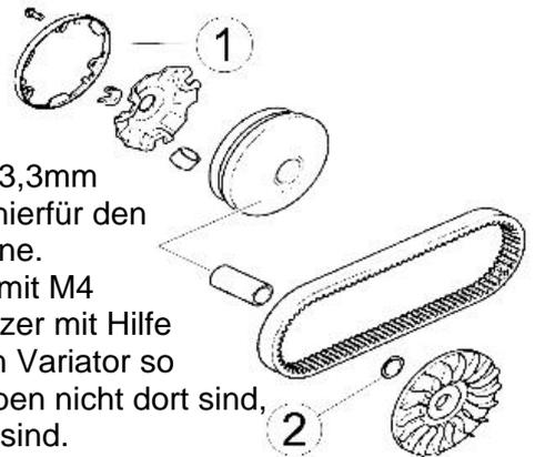
**WICHTIG:** Die originale Drossel-Distanzhülse **nicht** wieder verbauen! Die beiden mitgelieferten 0,5mm dicke U-Scheibe werden nun zwischen Variatorgleithülse und der dort original verbauten Scheibe zusammen unter die äußerer Riemenscheibe gelegt, so dass Riemenscheibe und Variator 1mm weiter auseinander sind (siehe Bild "2"). Siehe *Punkt 5*.
