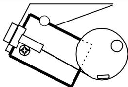
Der Drosselklappenanschlag wird zusammen mit dem Gaszughalter montiert. Hierbei kommt die original verwendete Kreuzschlitzschraube wieder zum Einsatz. Siehe *Punkt 5*.
